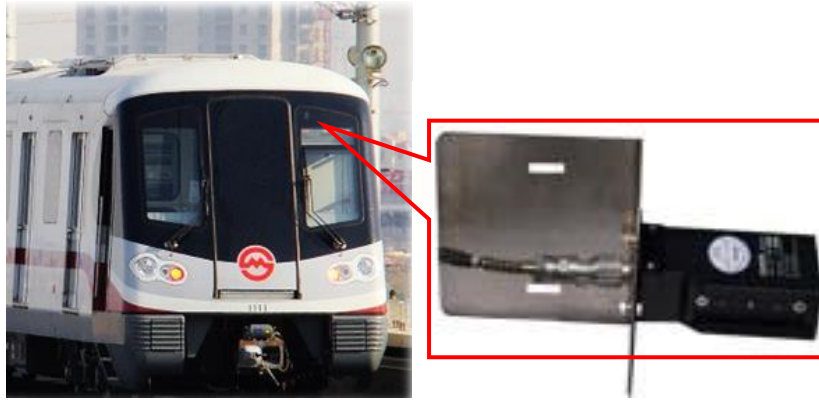
图 1.2 11A01 型列车光控制器及安装位置示意图
