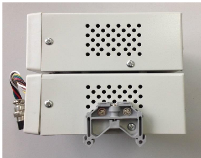
图 4.23 光敏节能控制器侧视图
