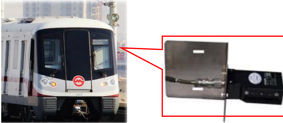
图 3.4 11A01 型列车光控制器及安装位置示意图
