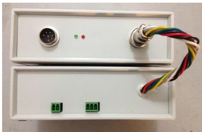
图 4.22 光敏节能控制器正视图
