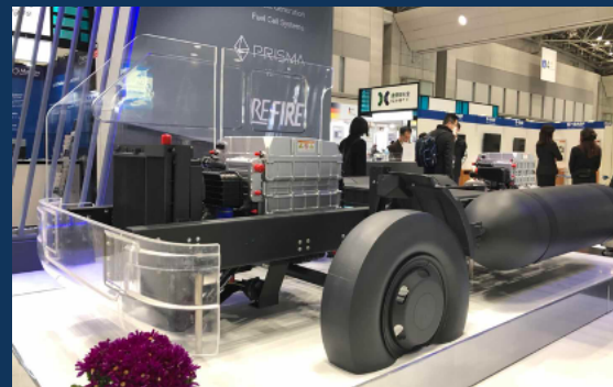
PRISMA 镜星系列 80kW 燃料电池系统
